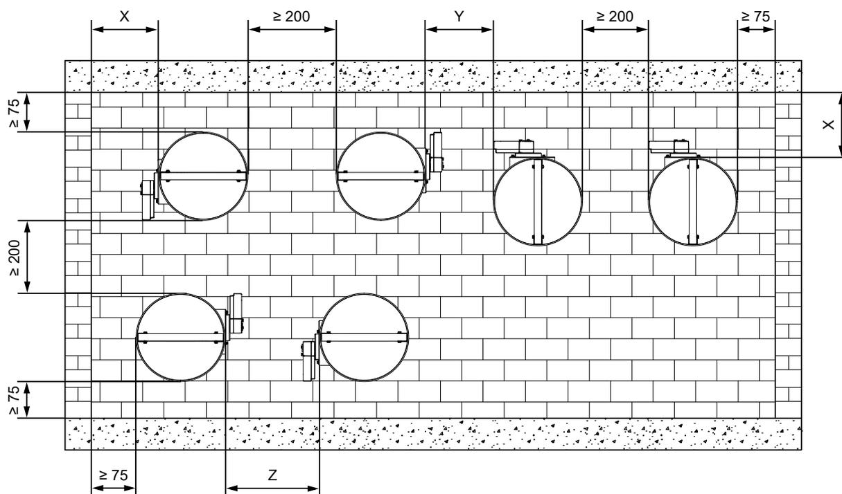
X = Distance minimale recommandée nécessaire pour accéder au mécanisme MODULAR  $\geq 200$  mm
