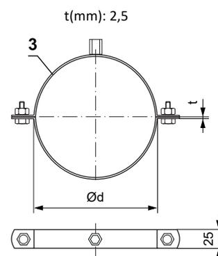
2x raccord à vis M10x30 ou tiges filetées M10.
