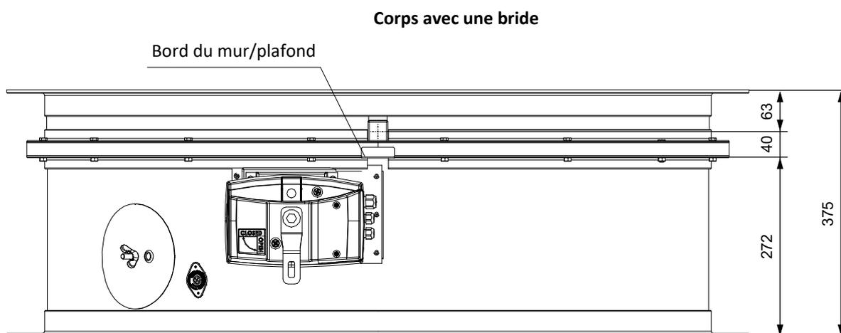
L'étiquette "BUILT IN EDGE" indique le bord recommandé de la construction coupe-feu (mur/plafond). Le clapet doit être installé de manière à ce que l'ensemble du clapet (en position fermée) se trouve dans la construction coupe-feu (mur/plafond) et qu'en même temps le mécanisme et les ouvertures d'inspection soient librement accessibles.
