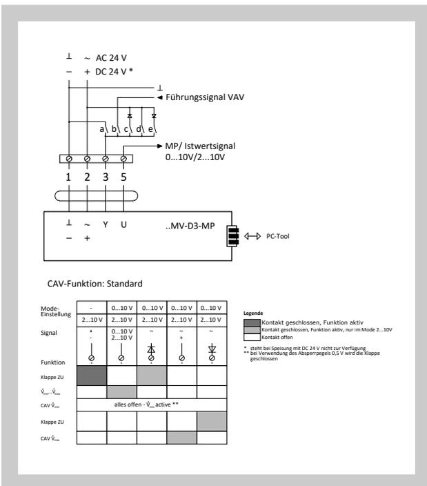
**Abb. 8 Luftstromregelung in MASTER-SLAVE-Verbindung für LMV-D3-MP, NMV-D3-MP, SMV-D3-MP, LMV-D3-MF.1 MDK\* und NMV-D3-MF.1 MDK\***
