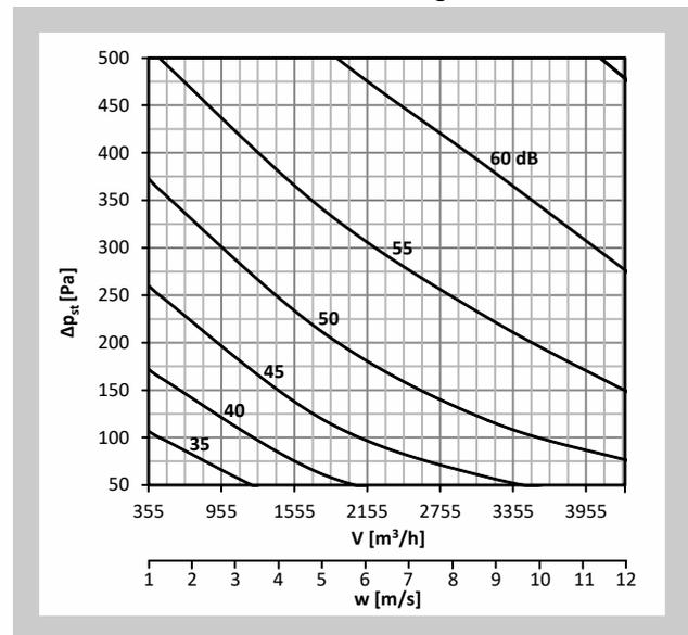
Diagramm Nr. 28 Schallleistungspegel  $L_{WA}$  [dB(A)] außerhalb der Anschlussleitung - DN400, nicht isoliert
