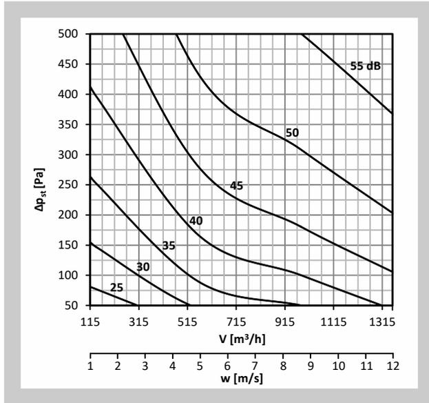
Diagramm Nr. 23 Schalleistungspegel  $L_{WA}$  [dB(A)] außerhalb der Anschlussleitung - DN225, nicht isoliert
