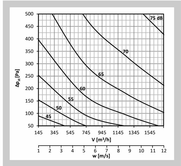
Diagramm Nr. 9 Schalleistungspegel  $L_{WA}$  [dB(A)] innerhalb der Anschlussleitung - DN250
