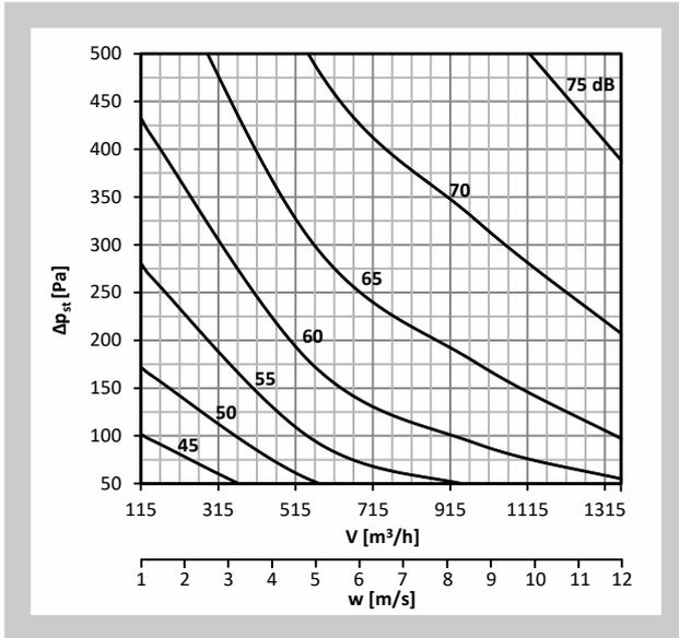
Diagramm Nr. 8 Schalleistungspegel  $L_{WA}$  [dB(A)] innerhalb der Anschlussleitung - DN225
