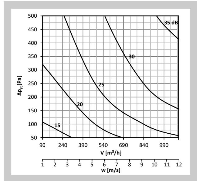
Diagramm Nr. 37 Schalleistungspegel  $L_{WA}$  [dB(A)] außerhalb der Anschlussleitung - DN200, isoliert
