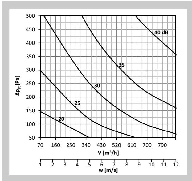
**Diagramm Nr. 36 Schalleistungspegel  $L_{WA}$  [dB(A)] außerhalb der Anschlussleitung - DN180, isoliert**
