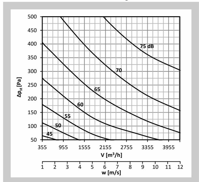
Diagramm Nr. 13 Schalleistungspegel  $L_{WA}$  [dB(A)] innerhalb der Anschlussleitung - DN400
