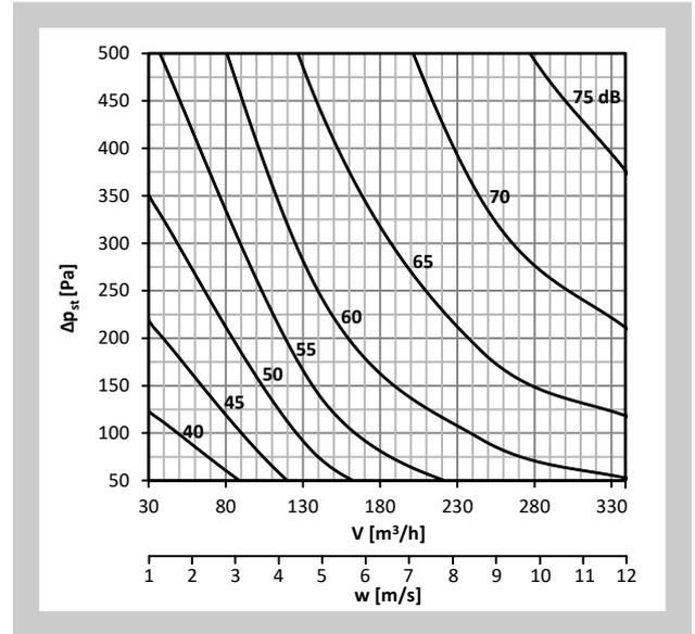
**Diagramm Nr. 3 Schalleistungspegel  $L_{WA}$  [dB(A)] innerhalb der Anschlussleitung - DN125**
