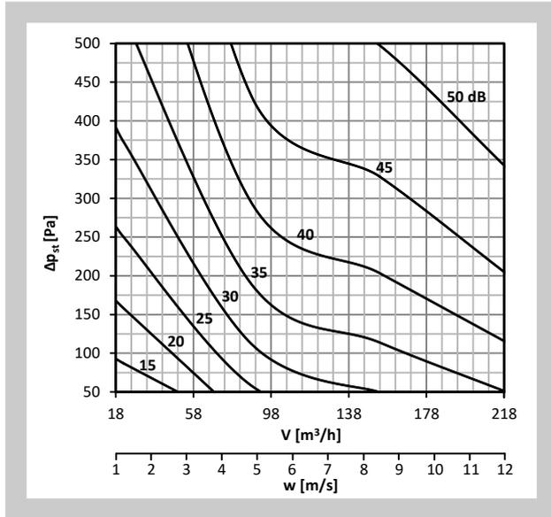
Diagramm Nr. 17 Schalleistungspegel  $L_{WA}$  [dB(A)] außerhalb der Anschlussleitung - DN100, nicht isoliert
