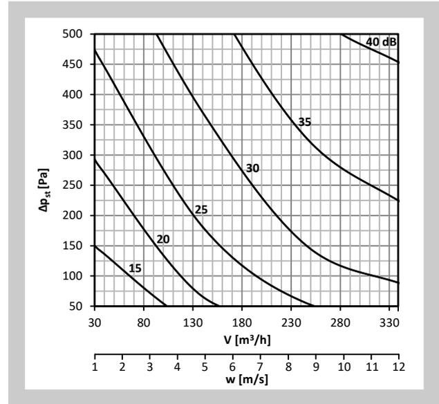
**Diagramm Nr. 33 Schalleistungspegel  $L_{WA}$  [dB(A)] außerhalb der Anschlussleitung - DN125, isoliert**
