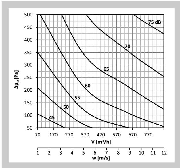
**Diagramm Nr. 6 Schalleistungspegel  $L_{WA}$  [dB(A)] innerhalb der Anschlussleitung - DN180**
