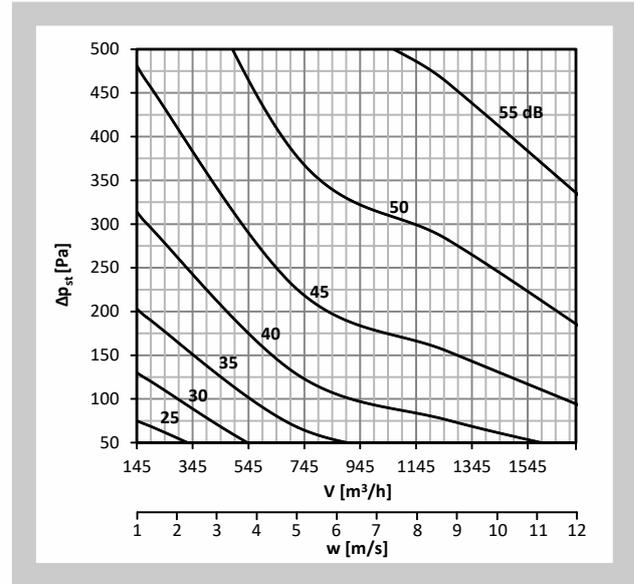
Diagramm Nr. 24 Schalleistungspegel  $L_{WA}$  [dB(A)] außerhalb der Anschlussleitung - DN250, nicht isoliert
