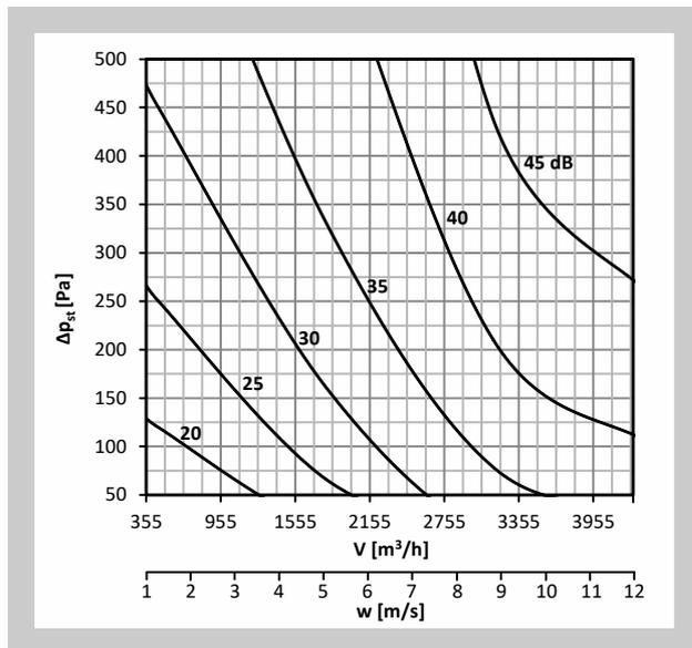
Diagramm Nr. 43 Schalleistungspegel  $L_{WA}$  [dB(A)] außerhalb der Anschlussleitung - DN400, isoliert
