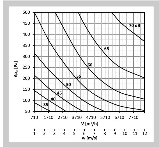
Diagramm Nr. 30 Schallleistungspegel  $L_{WA}$  [dB(A)] außerhalb der Anschlussleitung - DN630, nicht isoliert
