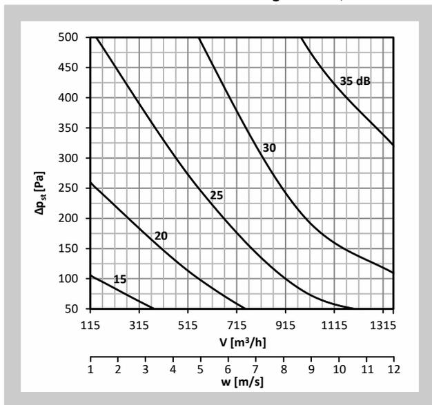
Diagramm Nr. 38 Schalleistungspegel  $L_{WA}$  [dB(A)] außerhalb der Anschlussleitung - DN225, isoliert
