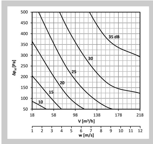
**Diagramm Nr. 32 Schalleistungspegel  $L_{WA}$  [dB(A)] außerhalb der Anschlussleitung - DN100, isoliert**
