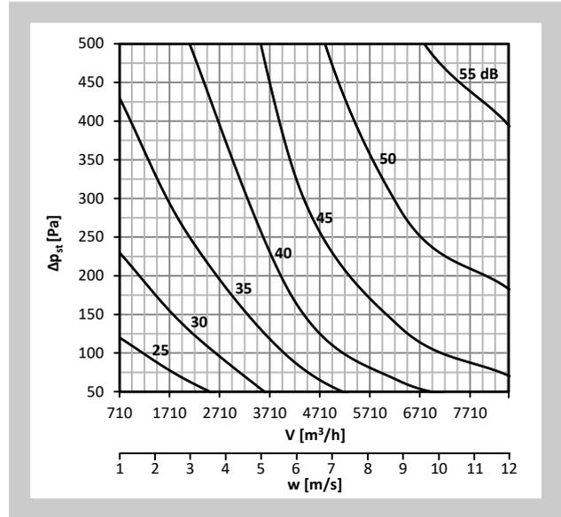
Diagramm Nr. 45 Schalleistungspegel  $L_{WA}$  [dB(A)] außerhalb der Anschlussleitung - DN630, isoliert
