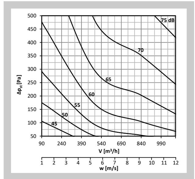
Diagramm Nr. 7 Schalleistungspegel  $L_{WA}$  [dB(A)] innerhalb der Anschlussleitung - DN200
