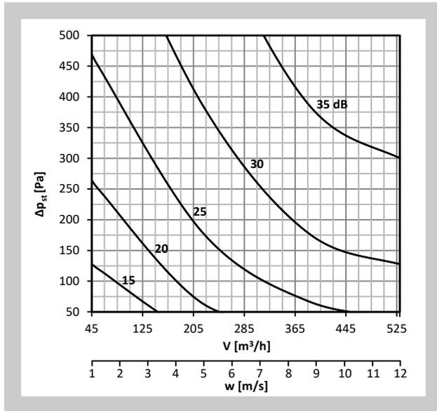
**Diagramm Nr. 34 Schalleistungspegel  $L_{WA}$  [dB(A)] außerhalb der Anschlussleitung - DN140, isoliert**
