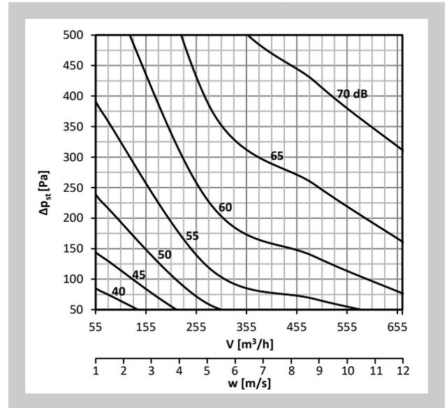
**Diagramm Nr. 5 Schalleistungspegel  $L_{WA}$  [dB(A)] innerhalb der Anschlussleitung - DN160**
