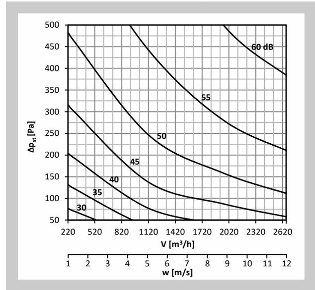
Diagramm Nr. 26 Schalleistungspegel  $L_{WA}$  [dB(A)] außerhalb der Anschlussleitung - DN315, nicht isoliert
