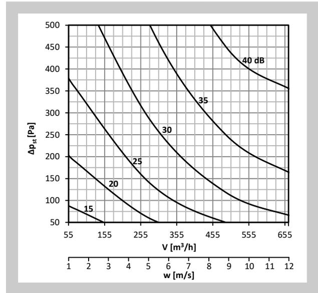
**Diagramm Nr. 35 Schalleistungspegel  $L_{WA}$  [dB(A)] außerhalb der Anschlussleitung - DN160, isoliert**
