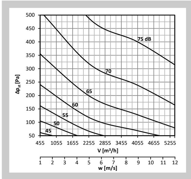
Diagramm Nr. 14 Schalleistungspegel  $L_{WA}$  [dB(A)] innerhalb der Anschlussleitung - DN500
