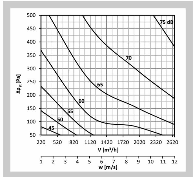
Diagramm Nr. 11 Schalleistungspegel  $L_{WA}$  [dB(A)] innerhalb der Anschlussleitung - DN315
