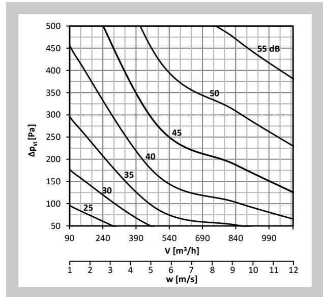
Diagramm Nr. 22 Schalleistungspegel  $L_{WA}$  [dB(A)] außerhalb der Anschlussleitung - DN200, nicht isoliert
