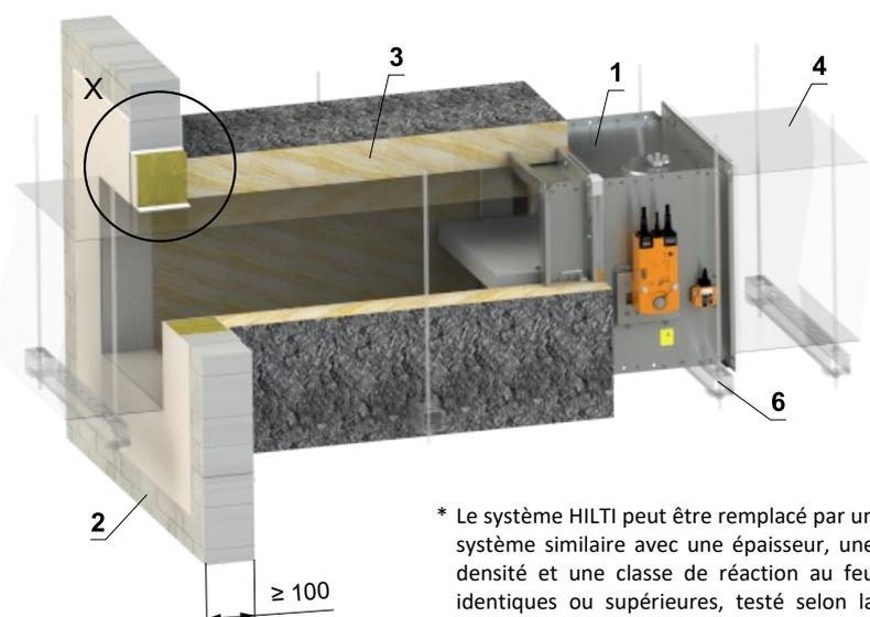
\* Le système HILTI peut être remplacé par un système similaire avec une épaisseur, une densité et une classe de réaction au feu identiques ou supérieures, testé selon la norme EN 1366-3.
