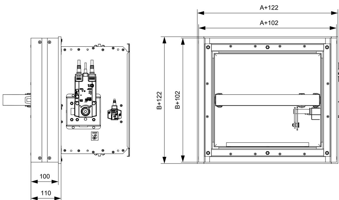
Dans le mur en plaques de plâtre - cadre de montage E3
