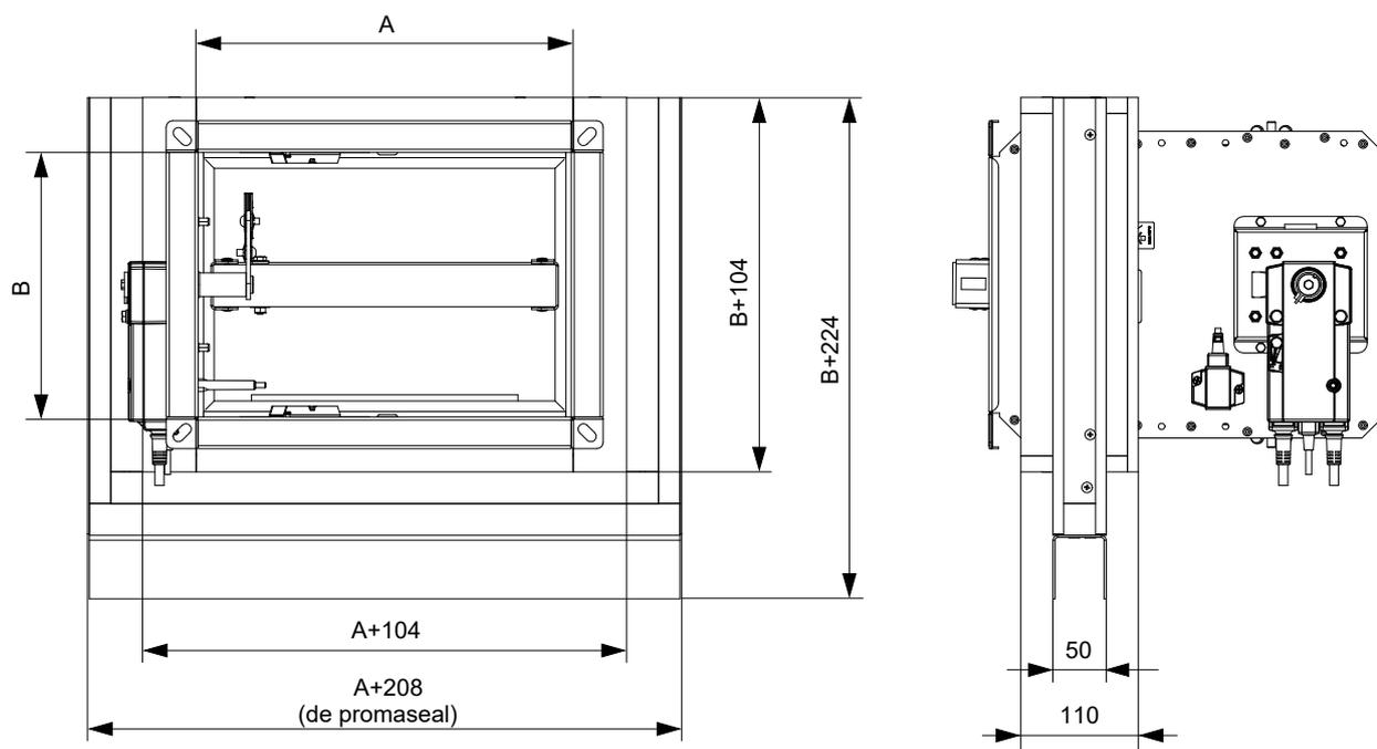
Dans le mur en plaques de plâtre - sous plafond mobile - cadre de montage E5
