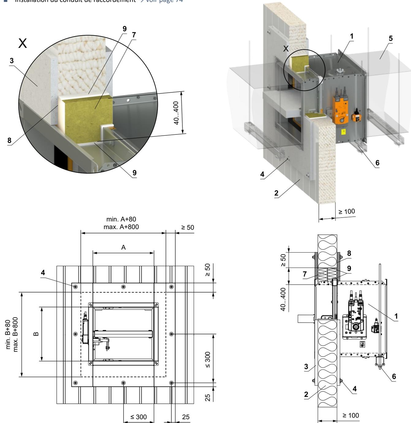
\* Le système HILTI peut être remplacé par un système similaire avec une épaisseur, une densité et une classe de réaction au feu identiques ou supérieures, testé selon la norme EN 1366-3.
