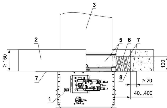
\* Le système HILTI peut être remplacé par un système similaire avec une épaisseur, une densité et une classe de réaction au feu identiques ou supérieures, testé selon la norme EN 1366-3.
