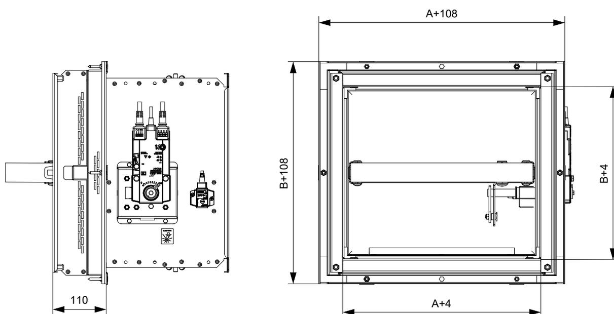
Dans le mur massif - cadre de montage E2
