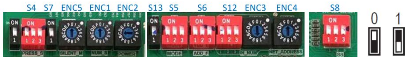
Obr. 28: Mikrosspínače na hlavní desce venkovní jednotky
