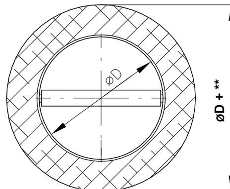
\*\* Mortier ou plâtre, clapet en mur rigide (ouverture circulaire)
