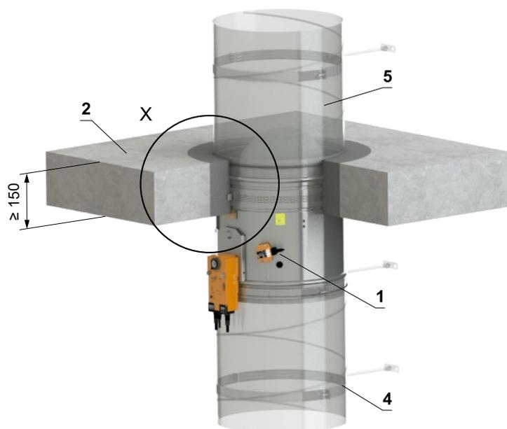
\* Pour la résistance au feu EI 45 S, l'espace entre la structure et le clapet doit être compris entre 50...150 mm.
