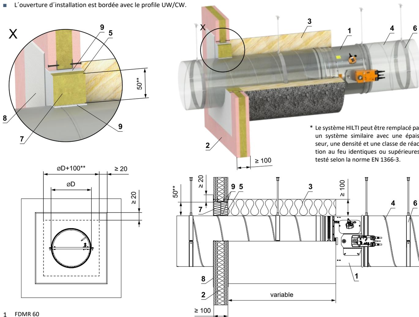
\* Le système HILTI peut être remplacé par un système similaire avec une épaisseur, une densité et une classe de réaction au feu identiques ou supérieures, testé selon la norme EN 1366-3.
