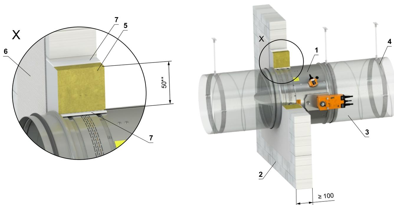
\*\* Pour la résistance au feu EI 45 S, l'espace entre la structure et le clapet doit être compris entre 30...75 mm.
