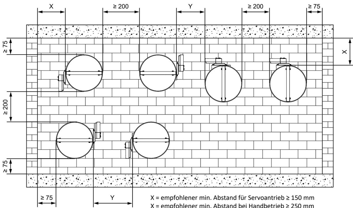
**Beschreibung der Einbauarten - MASSIVWÄNDE / MASSIVDECKEN**
