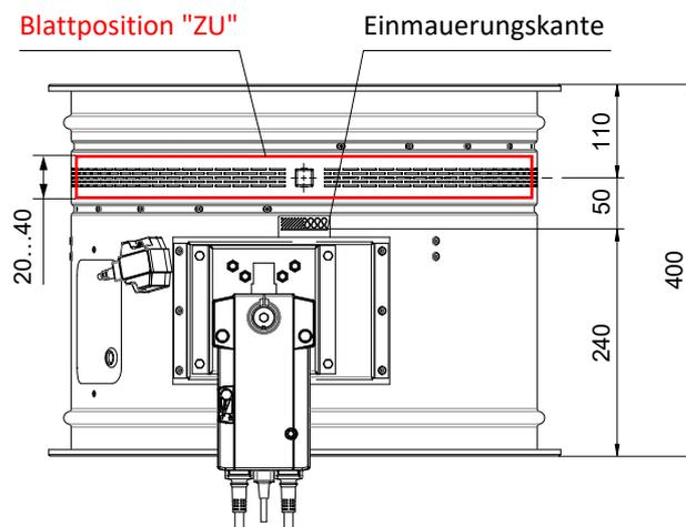
**Max. Entfernung von der Einmauerungskante (EK) zur Konstruktion** → siehe Blattstärke Seite 22
