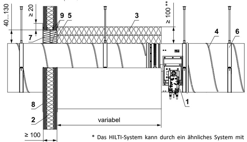
\* Das HILTI-System kann durch ein ähnliches System mit gleicher oder höherer Dicke, Dichte und Brandverhaltenklasse ersetzt werden, geprüft nach EN 1366-3
