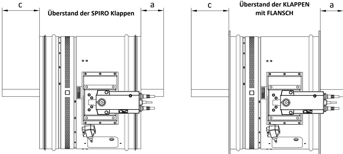
Werte "a" und "c" müssen bei der Projektierung der nachfolgenden lufttechnischen Leitungen berücksichtigt werden.
