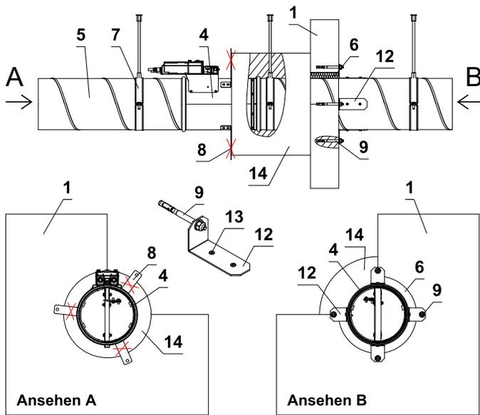
Außerhalb der massiven Deckenkonstruktion
