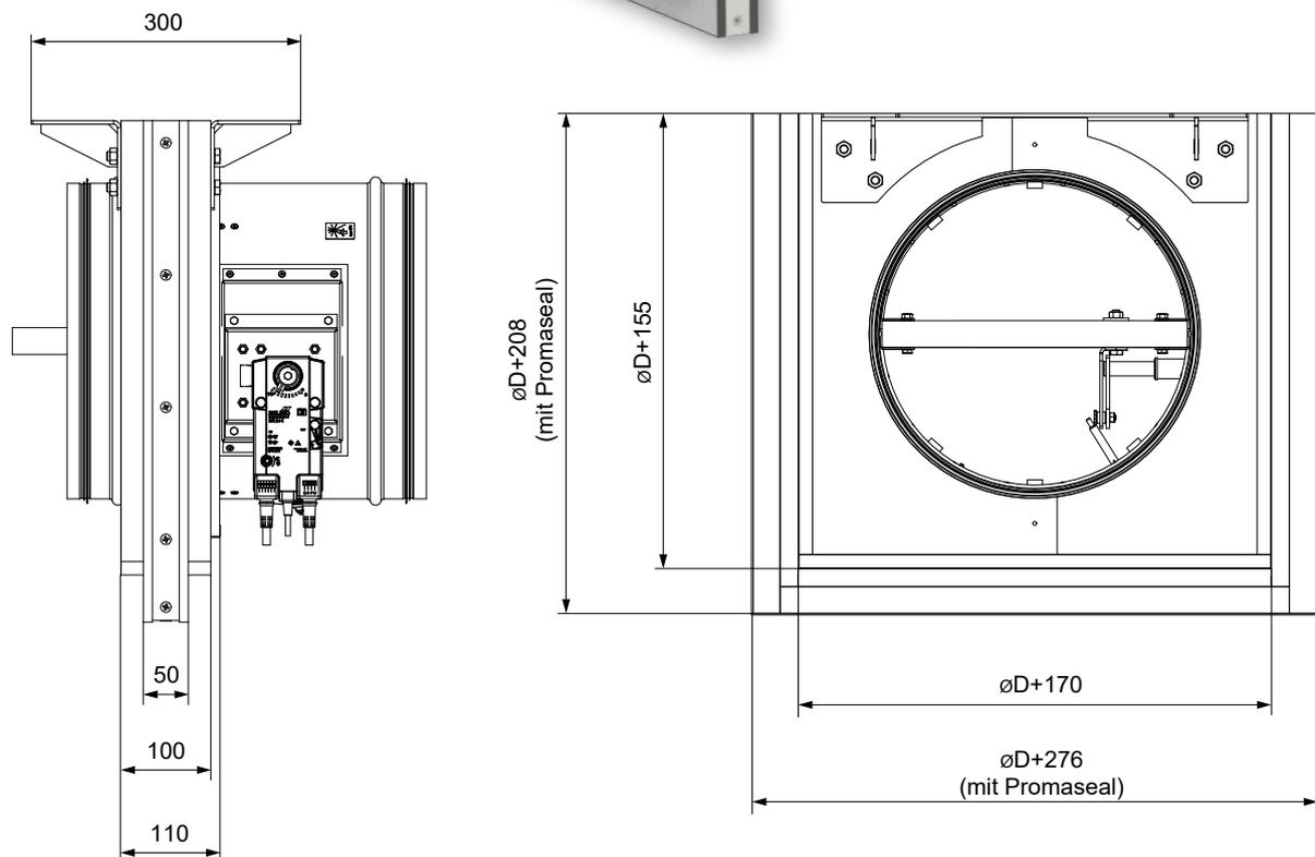
In die Leichtbauwand - unter der beweglichen Decke - Einbaurahmen R7
