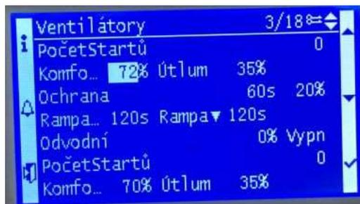
In der Zeile Komfort der Zuführungs-/Abführungsventilators mit Enter bestätigen und mit Pfeilen auf den Wert der Leistung des Ventilators [%] umschalten – mit Pfeilen auf den geforderten Wert ändern und mit Enter bestätigen.
