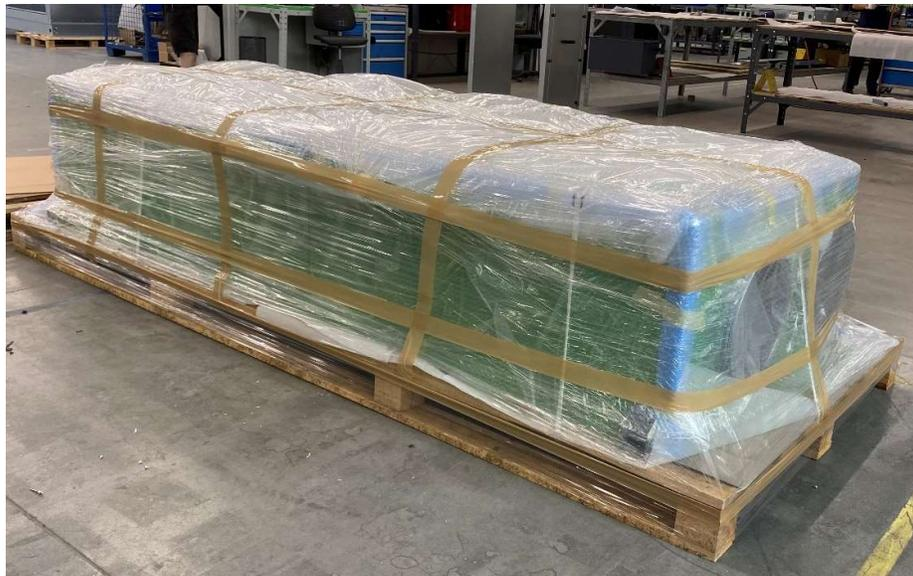
Das Gerät ist auf Paletten verpackt, die zur Manipulation mit Gabeln eines Hubstaplers oder eines Palettenwagens bestimmt sind. Bei der Verwendung müssen die Gabeln des Wagens immer unter der ganzen Kammer sein.
