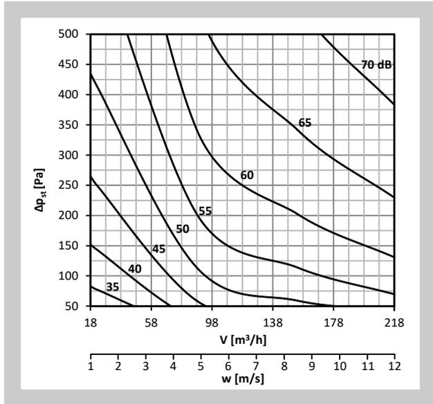
**Diagramm Nr. 2 Schalleistungspegel  $L_{WA}$  [dB(A)] innerhalb der Anschlussleitung - DN100**
