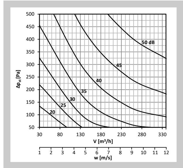
Diagramm Nr. 18 Schalleistungspegel  $L_{WA}$  [dB(A)] außerhalb der Anschlussleitung - DN125, nicht isoliert
