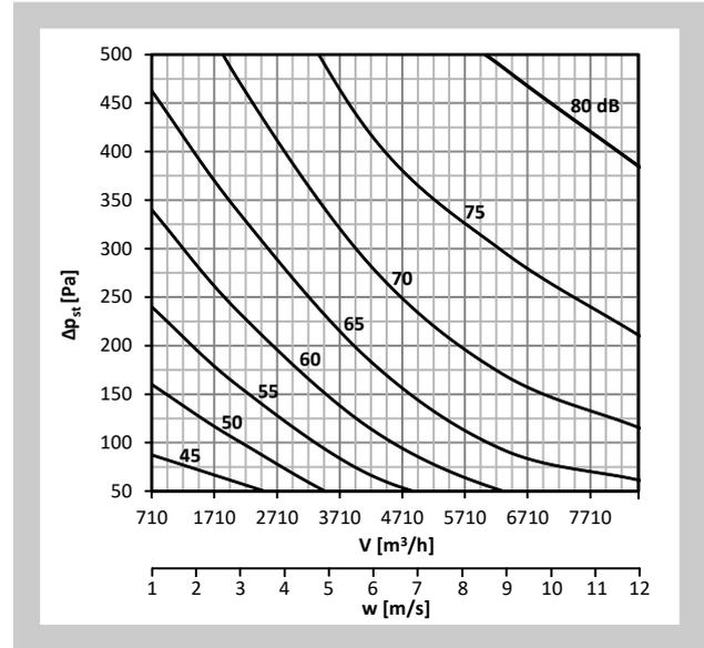
Diagramm Nr. 15 Schalleistungspegel  $L_{WA}$  [dB(A)] innerhalb der Anschlussleitung - DN630
