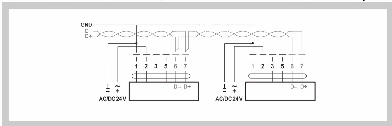
Abb. 11 Kompaktregler LMV-D3-KNX, NMV-D3-KNX
