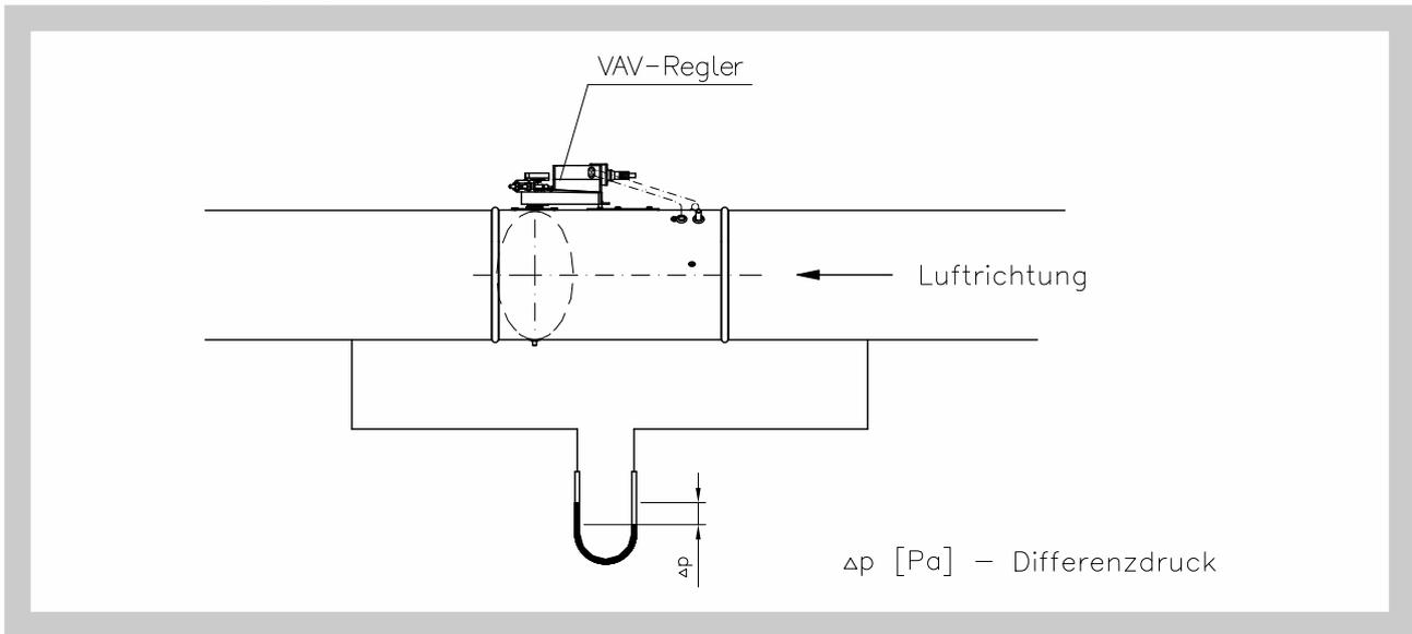
Abb. 4 Rohrdruckregelung
