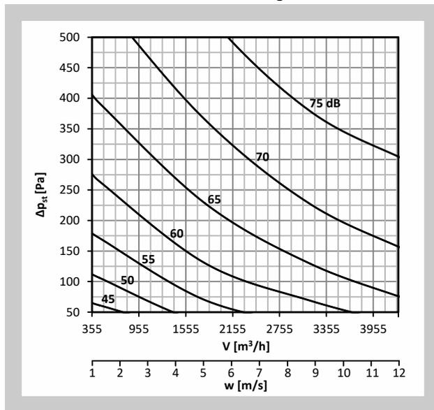
Diagramm Nr. 13 Schalleistungspegel  $L_{WA}$  [dB(A)] innerhalb der Anschlussleitung - DN400
