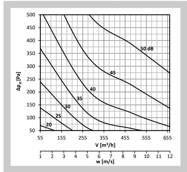
Diagramm Nr. 20 Schalleistungspegel  $L_{WA}$  [dB(A)] außerhalb der Anschlussleitung - DN160, nicht isoliert
