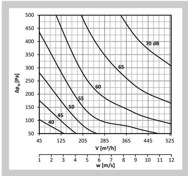
**Diagramm Nr. 4 Schalleistungspegel  $L_{WA}$  [dB(A)] innerhalb der Anschlussleitung - DN140**
