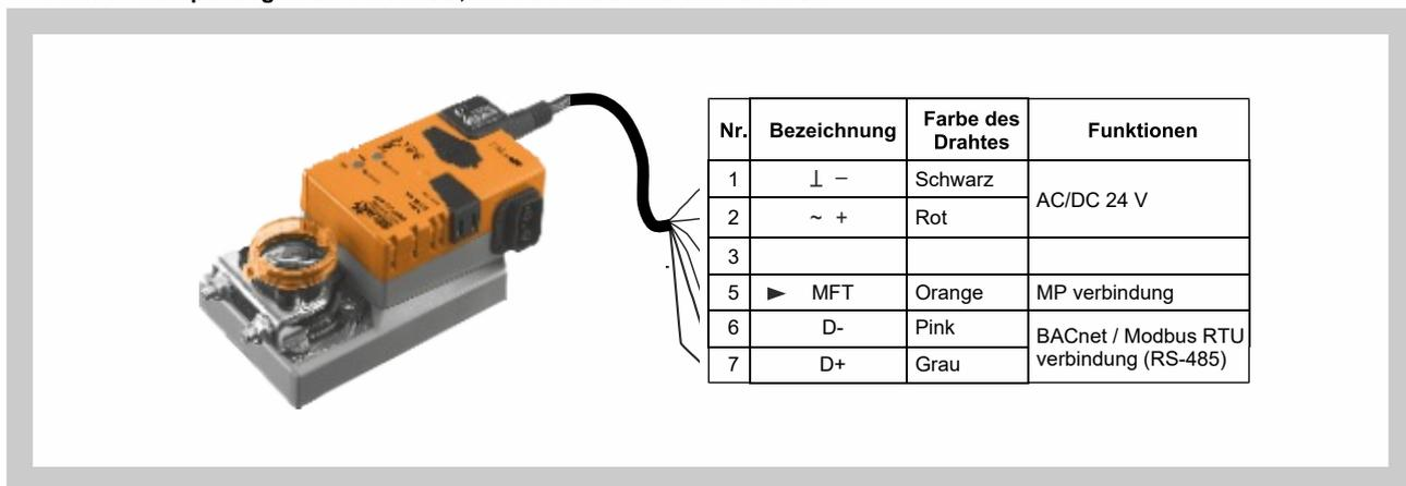
Abb. 10 Anschluss von Antrieben LMV-D3-MOD, NMV-D3-MOD und SMV-D3-MOD auf der seriellen RS-485-Leitung
