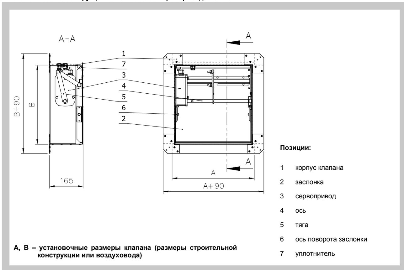
**3.4. Клапан «канального» исполнения с сервоприводом Belimo**
