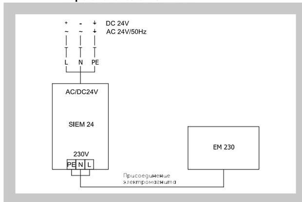
**Рис. 16 Импульсный переключатель SIEM 24**
