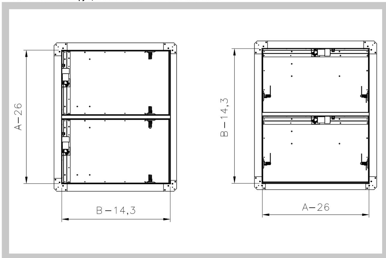
Рис. 7 Схема конструкции клапана ОКМ - кассетное исполнение
