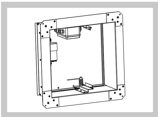
**1.7. Предел огнестойкости клапана в режиме дымового клапана – Е 90**
