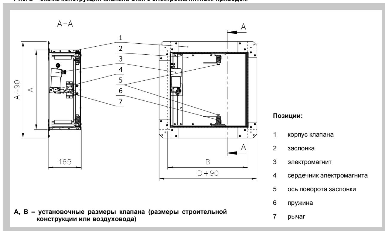
3.2. Клапан с электромагнитным приводом и концевым выключателем
