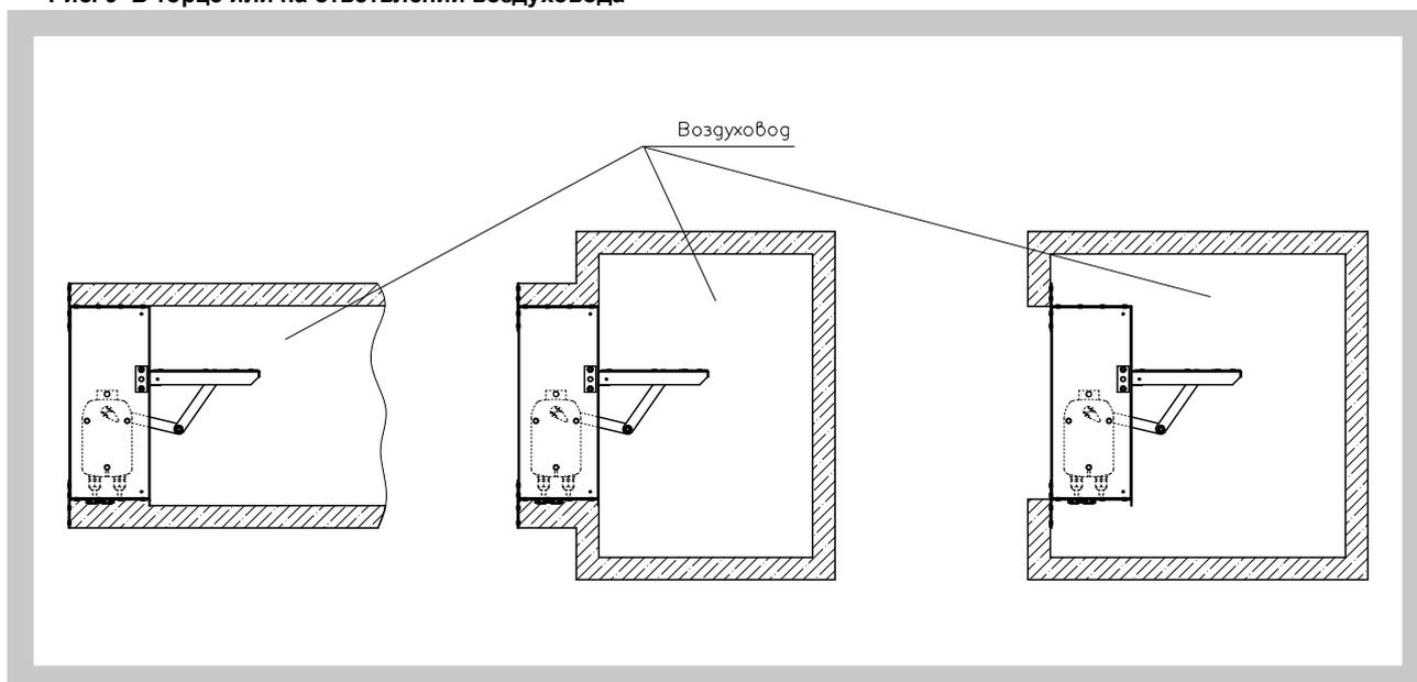
Рис. 10 Примеры установки клапанов «стенового» исполнения в горизонтальной плоскости
