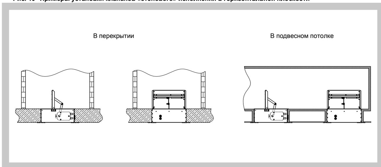
Рис. 11 Примеры установки клапанов «канального» исполнения
