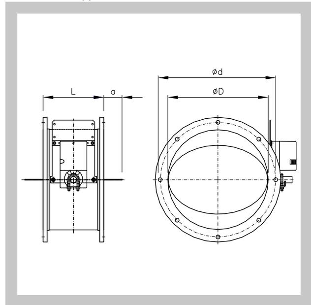
Klappe zum Anschluss an Wickelfalzrohre
