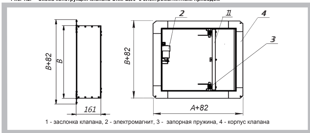
Рис. 1.2. Схема конструкции клапана ОКМ-ЕI90 с электромагнитным приводом
