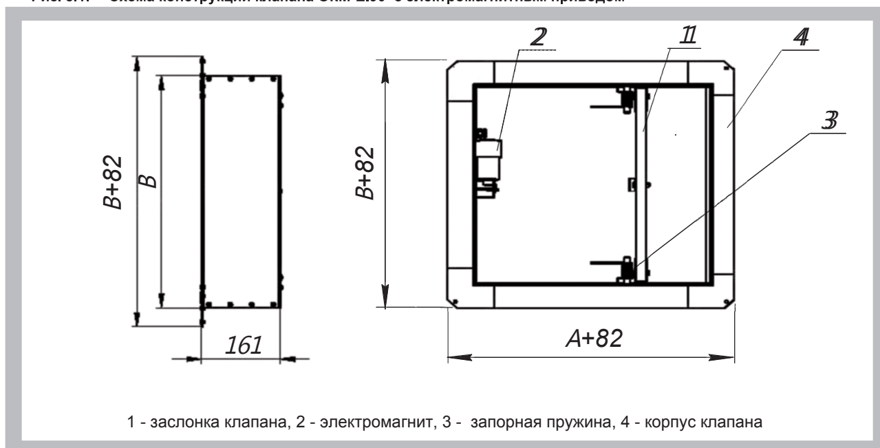
Рис. 3.1. Схема конструкции клапана ОКМ-ЕI90 с электромагнитным приводом
