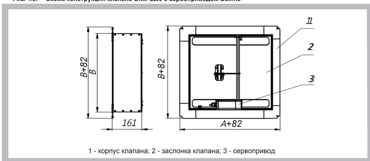
Рис. 1.3. Схема конструкции клапана ОКМ-ЕI90 с сервоприводом Belimo
