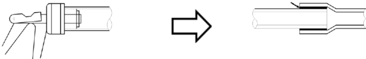
Obr. 15: Rozhrdlení trubek pro pájení
