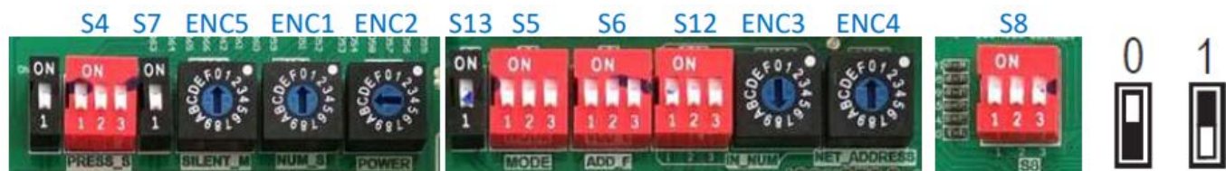
Obr. 29: Mikrosspínače na hlavní desce venkovní jednotky
