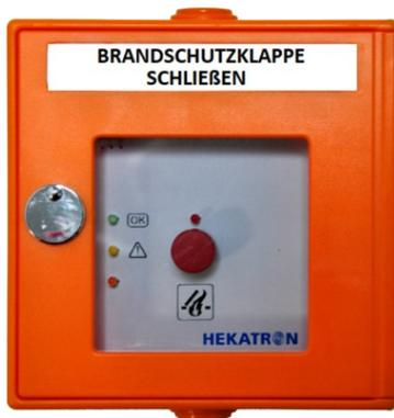
Die Handauslösung DKT 02 dient zur manuellen Alarmauslösung sowie zum Steuern von Brandschutzklappen. Durch einmaliges kurzes Drücken des roten Tasters wird die Alarmschleife unterbrochen und der Abschluss nimmt die Sicherheitsstellung ein. Der schwarze, vom Gehäusedeckel verdeckte Taster ist für das Zurücksetzen vorgesehen.
