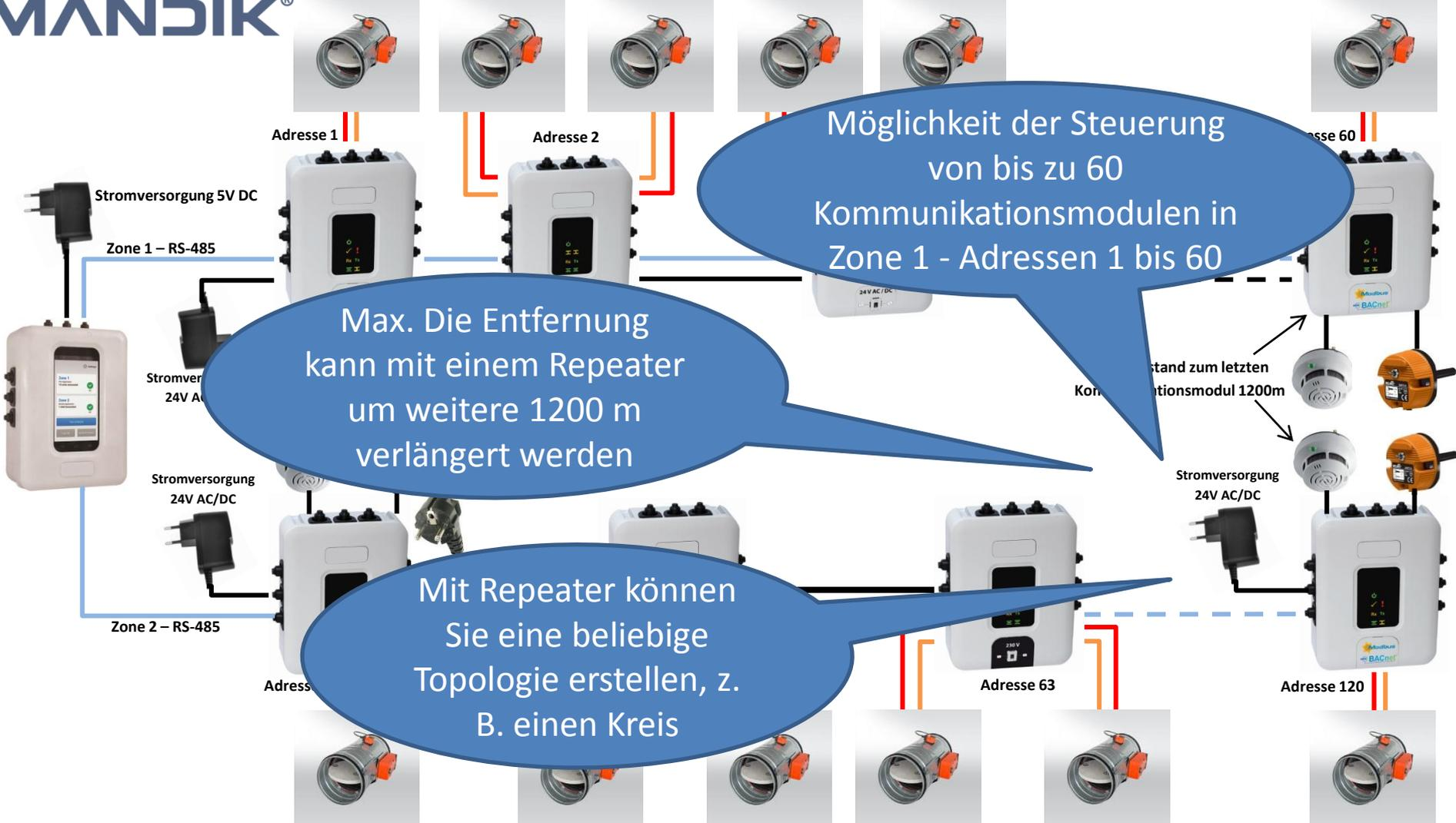
Möglichkeit der Steuerung von bis zu 60 Kommunikationsmodulen in Zone 1 - Adressen 1 bis 60
