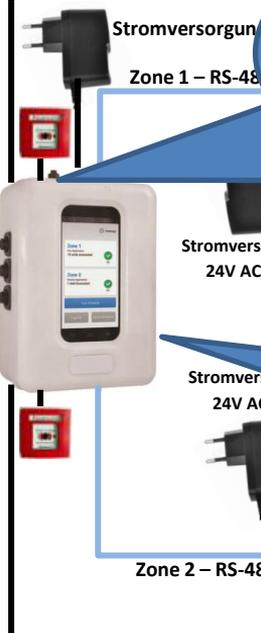
Das zentrale Steuermodul M60 ermöglicht den Anschluss an ein Lüftungsgerät und einen externen Alarm in jeder Zone. Das Lüftungsgerät schaltet aus, wenn in der jeweiligen Zone ein Alarm auftritt oder wenn eine Klappe in der Zone manuell geschlossen wird
