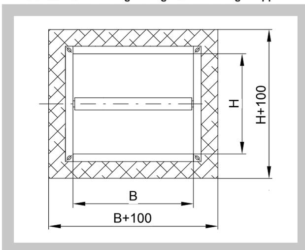
Abb. 23 Bauöffnung - runde Entrauchungsklappe
