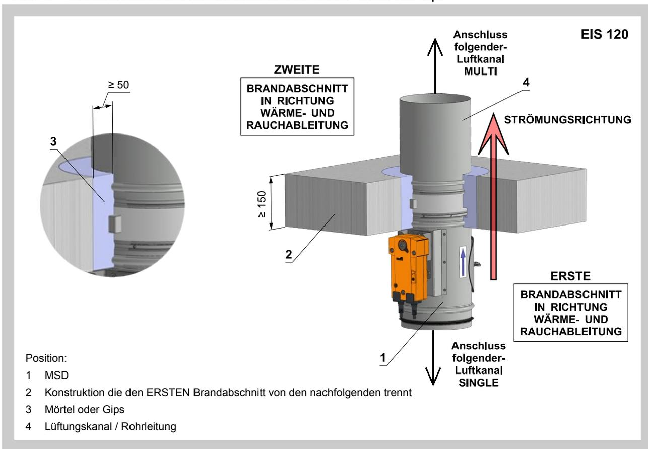
Abb. 41 Trennkonstruktion zwischen Luftkanal SINGLE / MULTI - Weichschott
