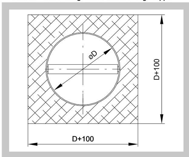
Abb. 24 Bauöffnung - runde Entrauchungsklappe
