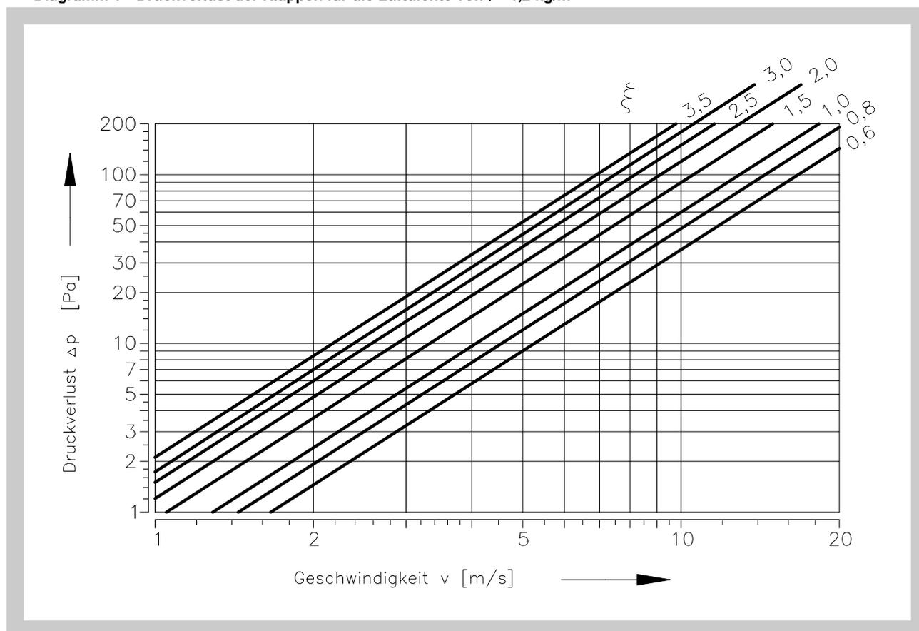
**Tab. 10 Koeffizient des örtlichen Druckverlustes  $\xi$  (-) - eckige Entrauchungsklappe**
