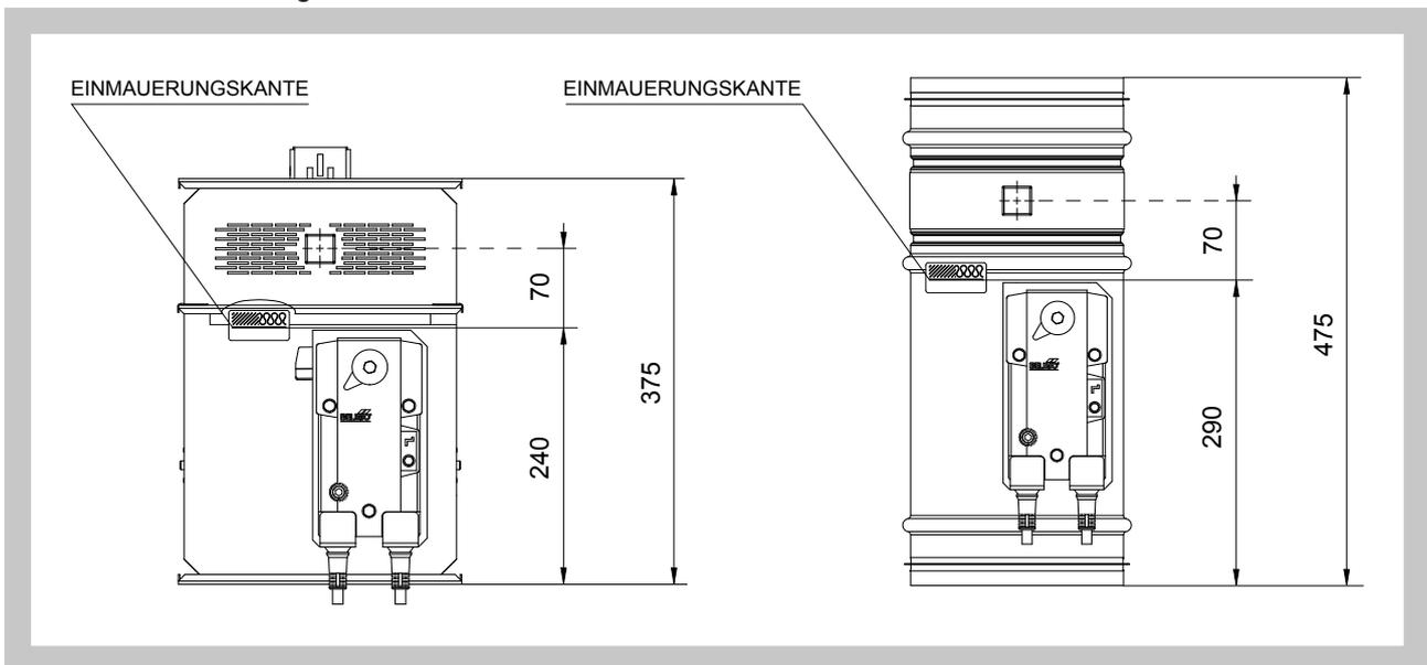
Durch den Aufkleber "Einmauerungskante" wird empfohlen die Einmauerungsgrenze einzuhalten. Die Klappe muss so installiert sein, dass sich das ganze Klappenblatt - in geschlossener Position, in der Konstruktion befindet und gleichzeitig die Revisionsöffnung als auch der Betätigungsmechanismus frei zugänglich ist.
