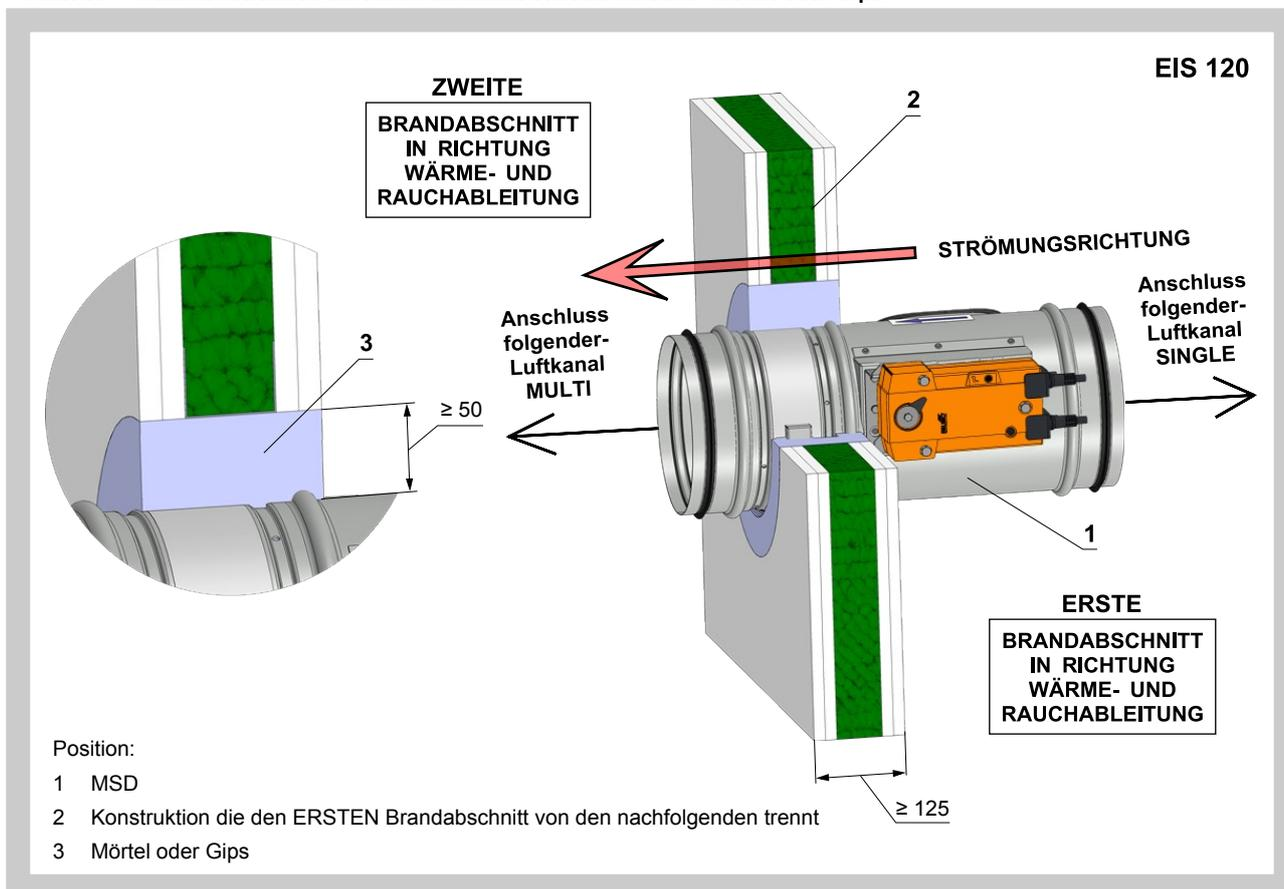
Abb. 34 Trennkonstruktion zwischen Luftkanal SINGLE / MULTI - Weichschott
